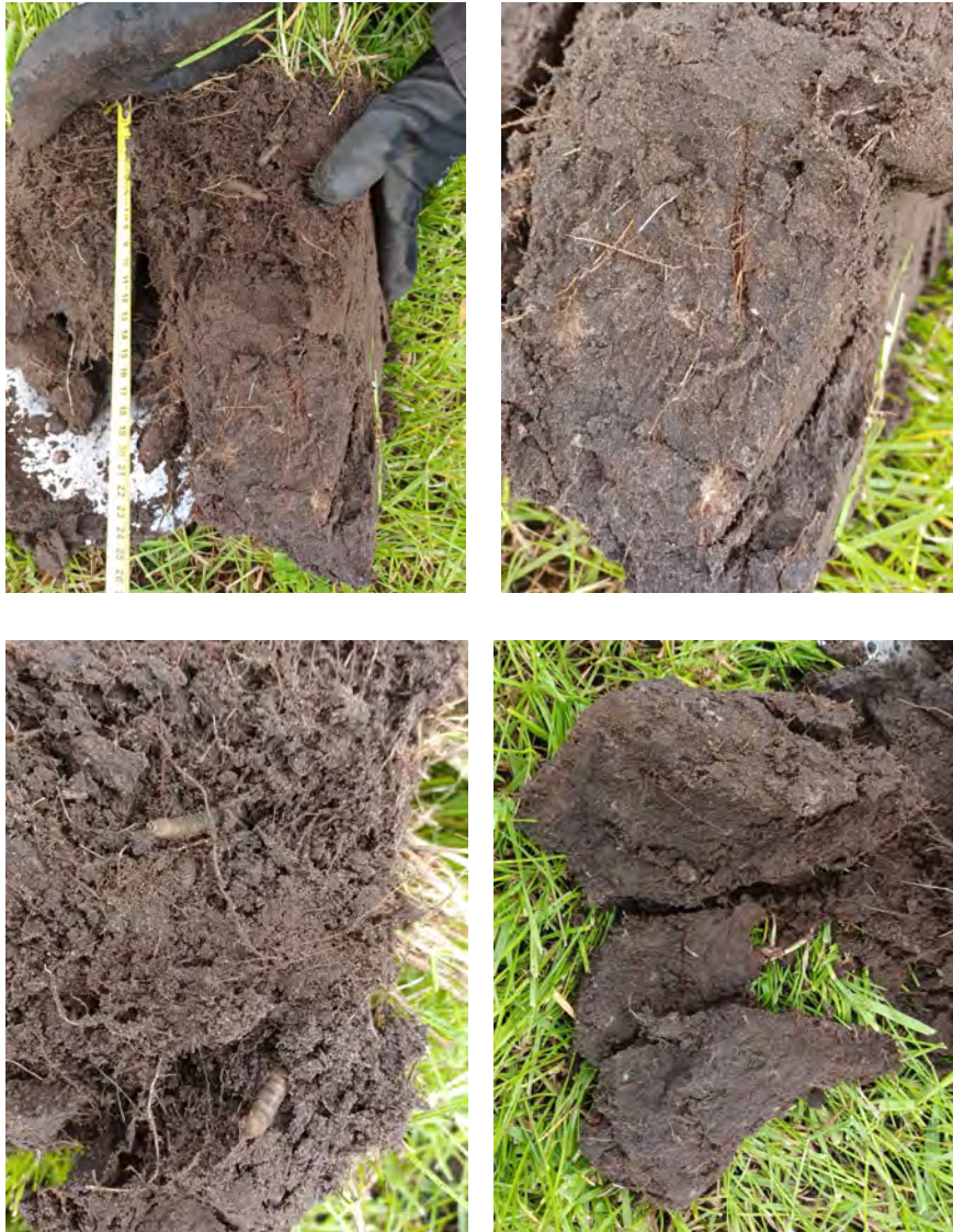
Figuur 16, 17, 18 en 19 In bovenstaande afbeeldingen zijn afgestorven wortels, roestvlekken, emelten en scherpe breukvlakken waar te nemen.
