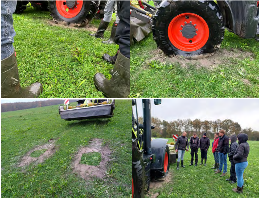
Figuur 46 t/m 49. Mark de Beer liet met behulp van kalk het effect zien van verlaagde bandenspanning: een groter contactoppervlakte met de bodem.
