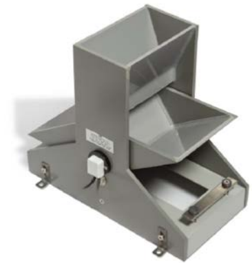
Figuur 3.3 Links: schematische weergave van de proefopzet. Rechts: met behulp van een debietmeter is oppervlakkige afspoeling continue gemeten .
