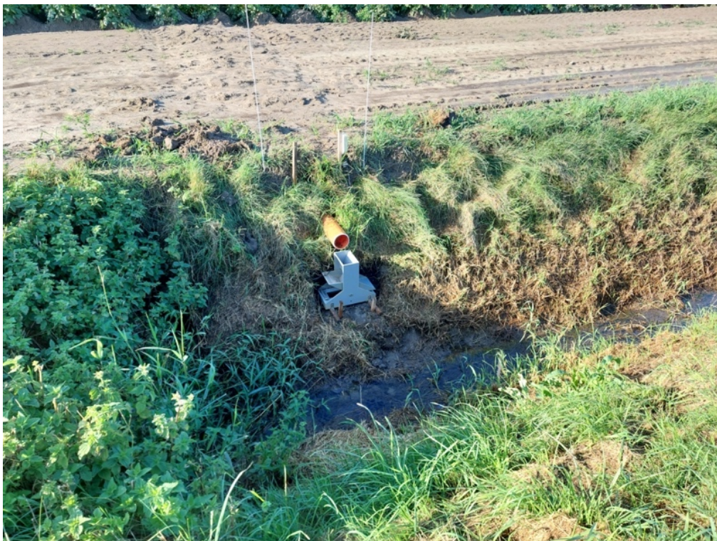
Figuur 4.6 Meetopstelling bij de basismetingen. Bij deze proeflocaties werd op één plek het van het perceel afspoelende water gemonitord.
