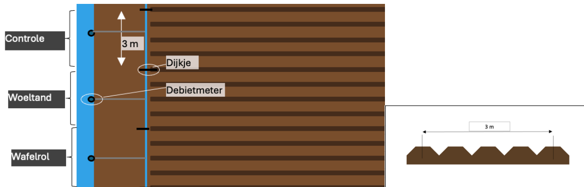
Figuur 3.2 Links: schematische opzet van de afspoelingsproef, deze opzet in zes keer herhaald. Rechts: de behandelingen beginnen en eindigen op het midden van de rug.
