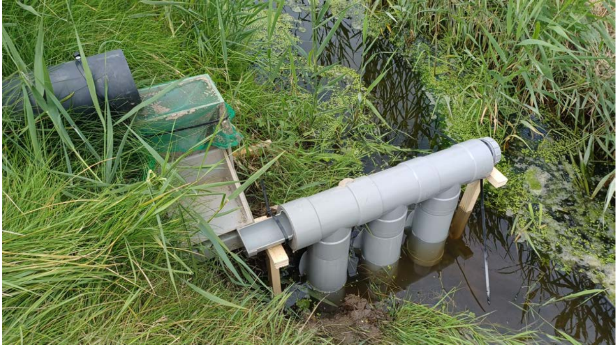
Figuur 6.2: Meetopstelling om afspoelend water vanuit de debietmeter op te vangen in een drietal monsternameflessen.
