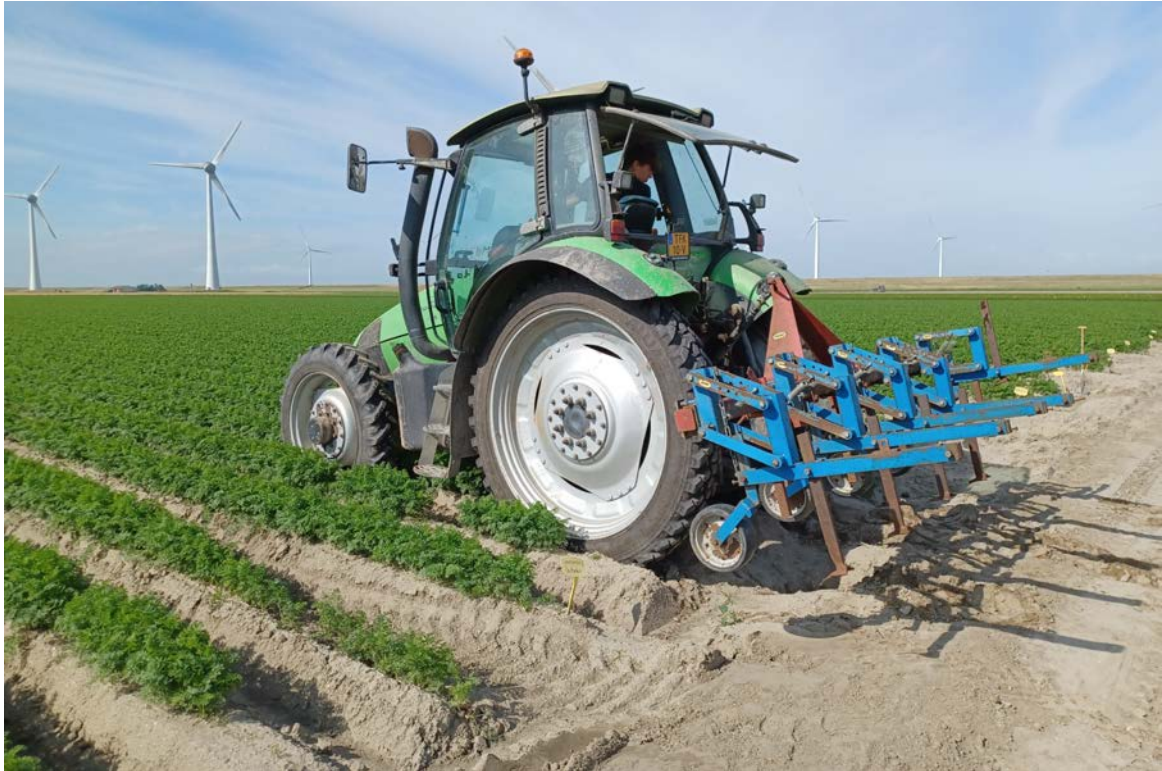
Figuur 2.1 De grond tussen de ruggen wordt opengetrokken met behulp van een woeltand.
