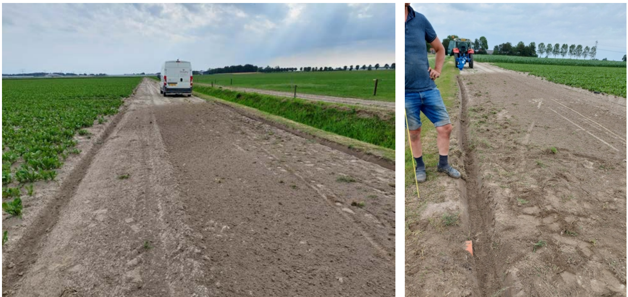
Figuur 2.6 De cascadegreppel in het onderzoek bestaat uit een afvoergreppel voor het gewas langs. Als deze vol is stroomt het water over het kavelpad naar de tweede greppel voor de sloot langs (foto links). In de tweede greppel is de afvoer gemeten (foto rechts).
