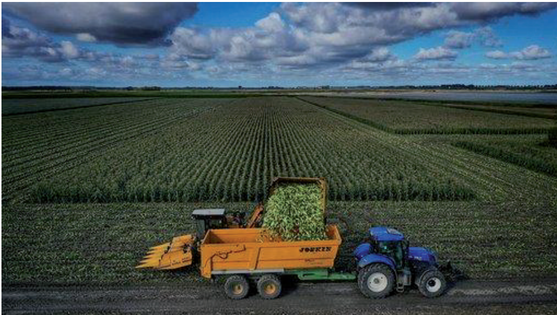
Figuur 3.2 Een suikermaisplukmachine met trekker en kieper vanaf de zijkant.
