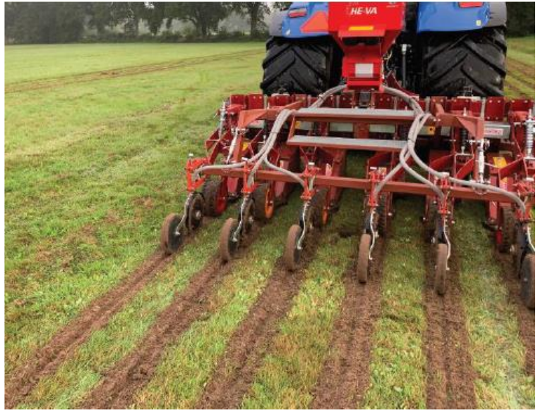
Figuur 12: Doorzaaien van grasland met een strokenfrees
